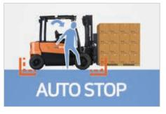
**OSS (Operator Sensing System)**
